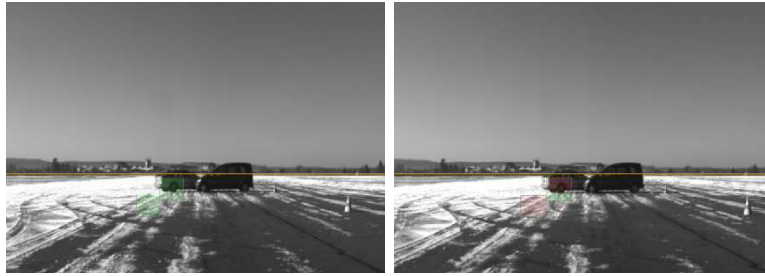
Abbildung 6.1: Frame 141 und 144 aus der Malmshiem Sequenz mit Hindernissen im Focus of Expansion. Die getrackten Regionen sind im linken Bild grün markiert. Im rechten Bild sind die Hindernishypothesen oberhalb des Fußpunktes rot markiert. Die gelbe Linie ist der Horizont.
