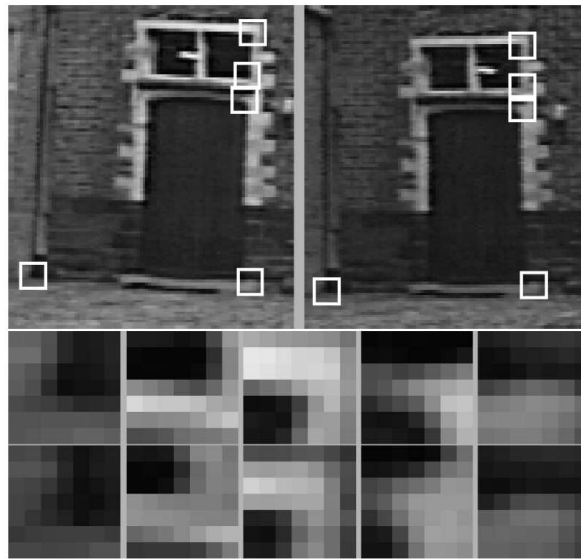
Abbildung 3.7: Oben die zwei Bilder mit markierten Regionen, welche unterhalb der Bilder vergrößert dargestellt sind. Die Berechnung der Korrelationskoeffizienten für die 5 \times 5 möglichen Matches sind in Tabelle 3.1 abgegeben [29].
